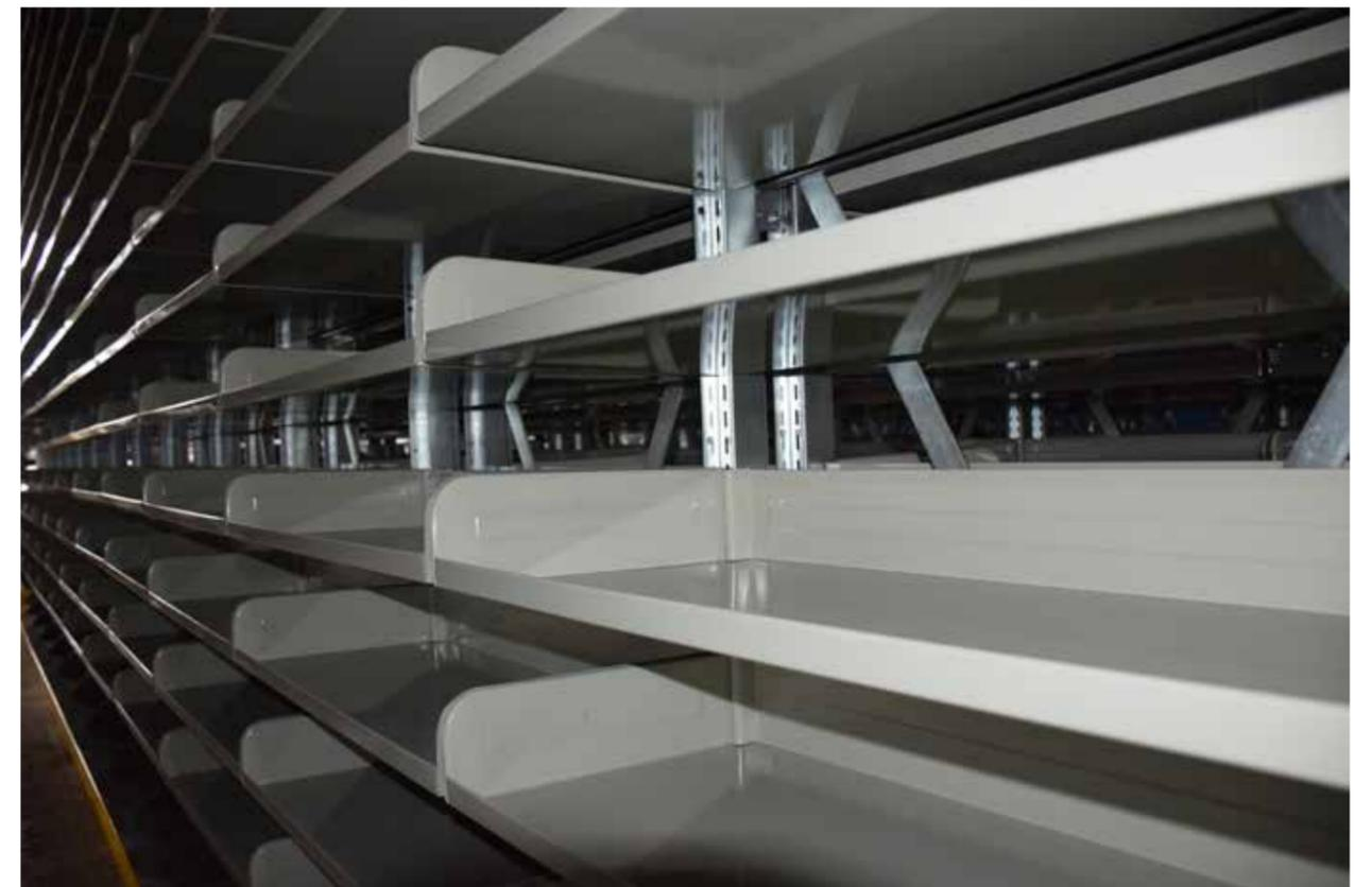
Con l'implementazione della Scaffalatura Doppio Rapid il sistema di stoccaggio classico a prelievo manuale e passerelle viene sintetizzato e semplificato con corsie di scaffalatura EURODUTO a tutt'altezza servite da ambo i lati da carrelli di presa semiautomatici.
