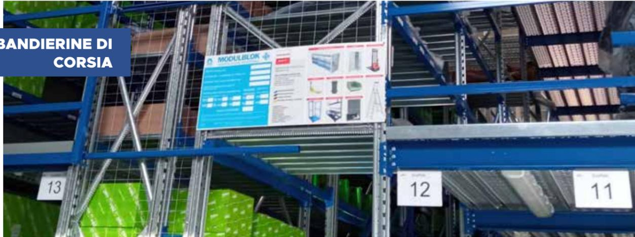
Divisorio in tubolare rivestito per stoccaggio elementi di carrozzeria.
